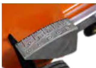
Indicateur de profondeur de coupe
