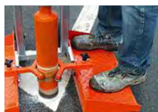
Le poids de l'opérateur assure le maintien
