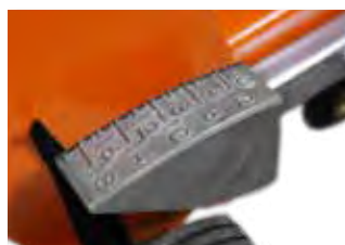
Indicateur de profondeur de coupe
