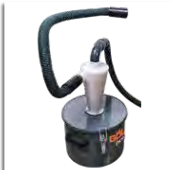
Filtre cyclonique servant de pré-filtre
