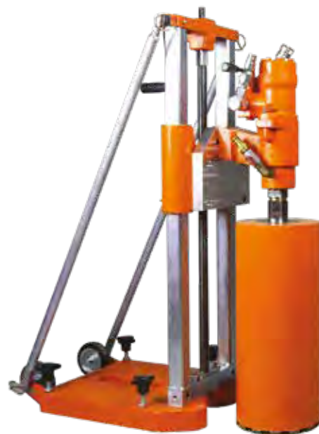
KB150 avec moteur hydraulique 140 bar, 300 min -1 (HBM100)
