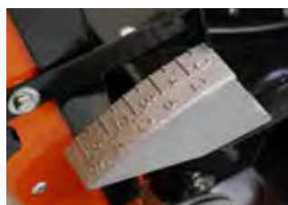
Indicateur de profondeur de coupe
