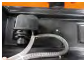
Pompe à eau
