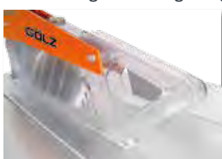
Ouverture/fermeture automatique du carter de protection
