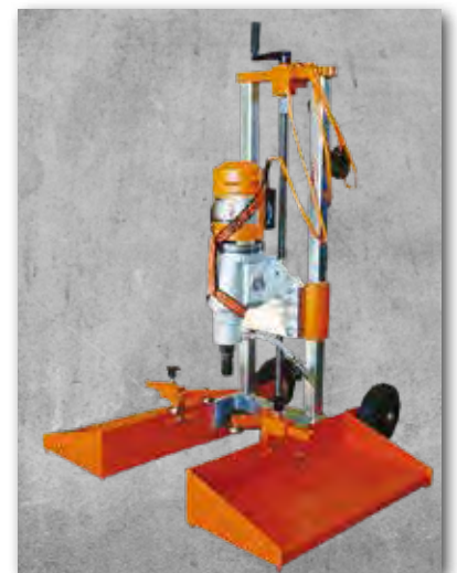
KB200 version électrique Moteur Bender BBM33L-extra
