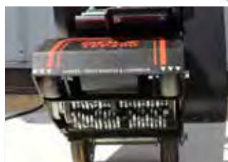
Tambour avec molettes en carbure de tungstène inclus
