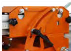
Profondeur de coupe réglable
