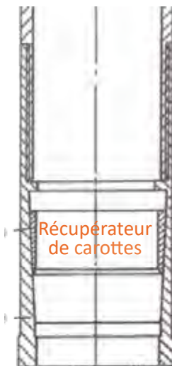
SYSTÈME B Avec récupérateur de carottes
