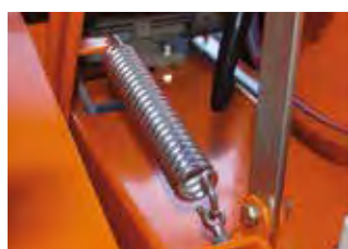
Tête de coupe à rappel par ressort réglable en hauteur
