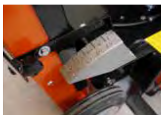
Indicateur de profondeur de coupe
