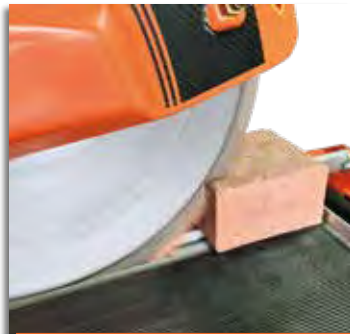
Aspiration au niveau du disque de coupe
