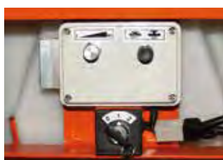
Démarrateur électrique et pupitre de réglage
