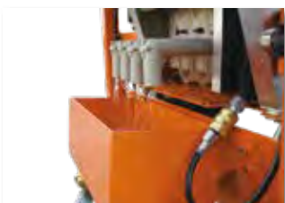
Évacuation de l'eau filtrée
